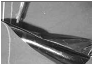
Extrémités du pare-vapeur SA 106 thermosoudées
